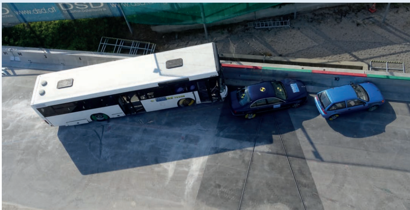
Bild 1: Höchste Restsicherheit inklusive: Ortbetonschutzwände werden bei den EN-1317-Prüfungen nur einmal aufgebaut und von allen Fahrzeugen am gleichen Punkt angefahren (Beispiel LT 201 BW: TB11, TB32, TB51)
