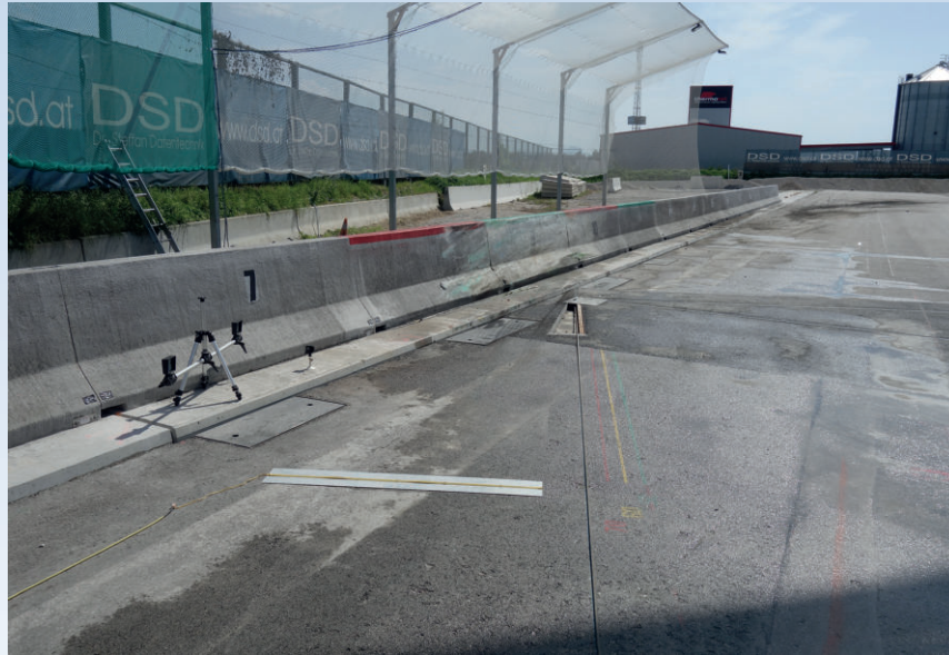
Bild 2: Einmalig installierte frei aufgestellte Schutzeinrichtung für Bauwerke LT 201 BW zeigt nach den TB11-, TB32- und TB51-Fahrzeuganprallen auf die gleiche Anprallstelle keine dynamische Durchbiegung und keine reparaturrelevanten Beschädigungen. An der Schutzeinrichtung verbleiben nach allen drei Fahrzeuganprallen „nur“ Farbmarkierungen und Kratzspuren (Foto: Linetech)
