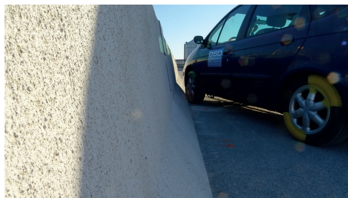
Bild 2: Betonschutzwand vor einem TB32-Anprallversuch. Der Erstkontakt findet im Regelfall immer über den anprallseitigen Vorderreifen statt
