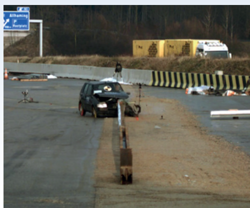
Bild 1: Zwei L2-Systeme im direkten TB11-Vergleich: Stahlenschutzplanke (links) mit dynamischer Durchbiegung von 0,24 m und Betonschutzwand (rechts) mit dynamischer Durchbiegung von 0,00 m. Auch im Betrieb erfordert jeder Fahrzeuganprall auf die Stahlenschutzplanke eine Reparatur (Fotos: GBG)
