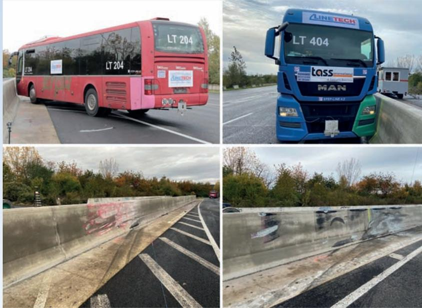
Bild 2: Die baugleichen Systeme LT 204, H2 und LT 404, H4b von Linetech jeweils vor und nach den TB51- und TB81-Anprallprüfungen. Ergebnis: Keine dynamische Durchbiegung, damit sind die Systeme hinterfüllbar, erfordern keine Reparaturen und keine Übergangskonstruktionen (Quelle: Linetech)
