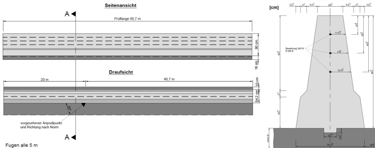
Kennzeichnend für die symmetrische Schutzeinrichtung LT 102 ME, H2 mit Step-Profil ist, dass sie in Ort-betonbauweise mit einem Gleitschalungsfertiger hergestellt wird. Die Wirkungsweise kann je nach Einbau-situation einseitig oder zweiseitig sein. Die Anprallprüfung erfolgte mit einer 16 cm hohen Asphaltunterlage. Die Einspannung des Systems in der Unterlage erfolgt über eine mittig unter der BSWO in der Unterlage befindliche Nut mit den Abmessungen 10 x 3,5 cm (Breite x Tiefe).
