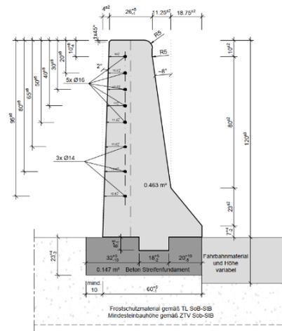
Kennzeichnend für die Schutzeinrichtung LT 404 mit Step-Line Profil ist, dass sie in Ortbetonbauweise mit einem Gleitschalungsfertiger hergestellt wird. Die Wirkungsweise ist einseitig. Die Anprallprüfung erfolgte mit einer 23 cm hohen Betonunterlage als Streifenfundament mit einer Breite von 70 cm.
