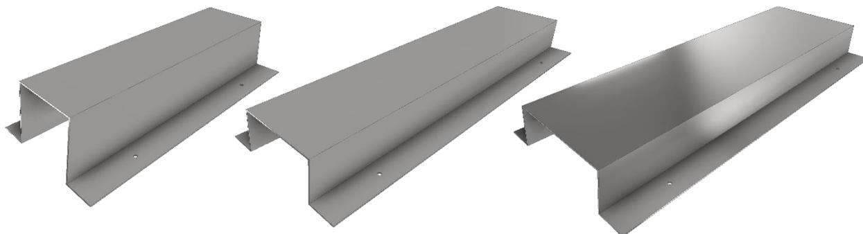
Das Systemelement LT 902 ist ein dauerhaftes Formteil für den Einbau in Ortbetonschutzwände; es dient der Durchleitung von Oberflächenwasser durch die Betonschutzwand.
