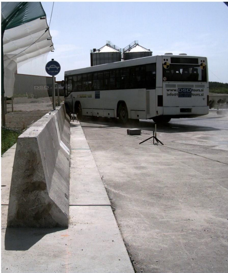
EN 1317 Bus Anprallversuch (TB51) auf einer "Riz Kap 1" Brückenkappen-Konstruktion, Quelle: Linetech, BAST
