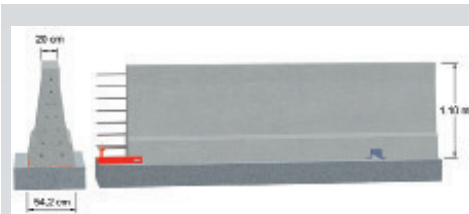
Abbildung 4: Mit Aufhaltestufe H4b und Wirkungsbereich W2 bietet die Ortbetonschutzwand LT 104 ME Sicherheit bei geringem Platzbedarf. Grafik: Linetechn
