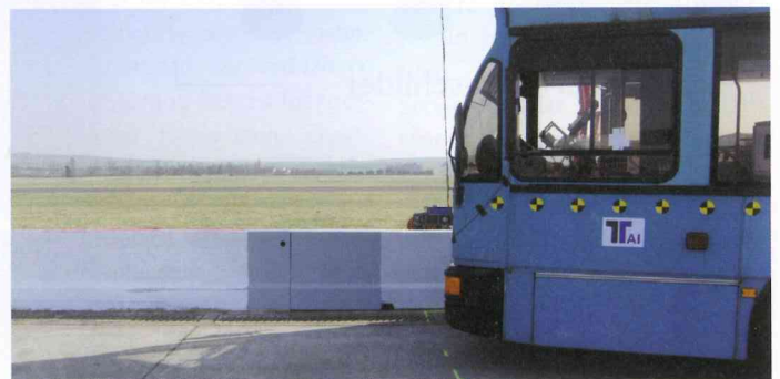
Bild 2: Die patentierte Schwert-Nut-Verbindung bietet geprüfte Sicherheit. Dieses Bild zeigt den LT 1 (linkes graues Element) als Teil der ersten Übergangskonstruktion beim Anprallversuch. Dabei wurde die Verbindung direkt angefahren
