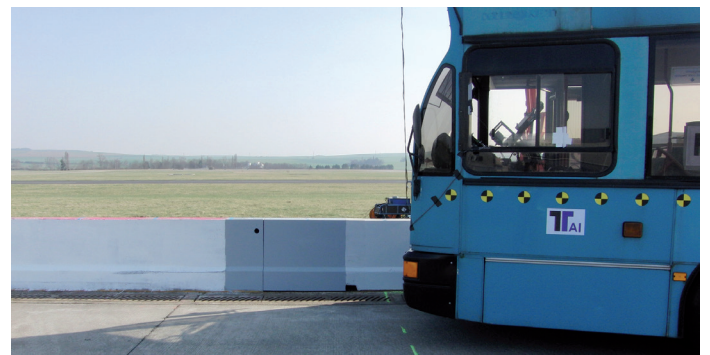
Bild 2: Die patentierte Schwert-Nut-Verbindung bietet geprüfte Sicherheit. Dieses Bild zeigt den LT 1 (linkes graue Element) als Teil der ersten Übergangskonstruktion beim Anprallversuch. Dabei wurde die Verbindung direkt angefahren
