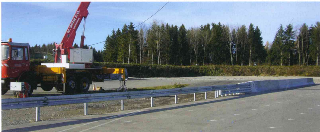
Die Übergangskonstruktion wurde nach DIN EN 1317 erfolgreich geprüft
