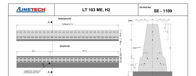
Kennzeichnend für die symmetrische Schutzeinrichtung BSWO LT 103 ME, H2 mit Step-Profil ist, dass sie in Ortbetonbauweise mit einem Gleitschalungsfertiger hergestellt wird. Die Wirkungsweise kann je nach Einbausituation einseitig oder zweiseitig sein. Die Anprallprüfung erfolgte mit einer 16 cm hohen Asphaltunterlage. Die BSWO ist frei aufgestellt.
