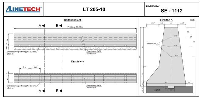
Kennzeichnend für die Schutzeinrichtung LT 205-10 mit Step-Line Profil ist, dass sie in Ortbetonbauweise mit einem Gleitschalungsfertiger hergestellt wird. Die Wirkungsweise ist einseitig. Die Anprallprüfung erfolgte mit einer 10 cm hohen Asphaltunterlage. Die Einspannung des Systems in der Unterlage erfolgt über eine mittig unter der BSWO Bewehrungsachse in der Unterlage befindliche Nut mit den Abmessungen 10 x 3 cm (Breite x Tiefe).
