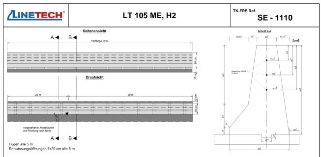
Kennzeichnend für die Schutzeinrichtung LT 105 ME, H2 mit Step-Line Profil ist, dass sie in Ortbetonbauweise mit einem Gleitschalungsfertiger hergestellt wird. Die Wirkungsweise ist einseitig. Die Anprallprüfung erfolgte mit einer 18 cm hohen Asphaltunterlage. Die Einspannung des Systems in der Unterlage erfolgt über eine mittig unter der BSWO Bewehrungsachse in der Unterlage befindliche Nut mit den Abmessungen 10 x 3 cm (Breite x Tiefe).
