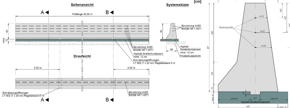
Kennzeichnend für die Schutzeinrichtung LT 205-SF, N2 mit Step-Line Profil ist, dass sie in Ortbetonbauweise mit einem Gleitschalungsfertiger hergestellt wird. Die Wirkungsweise ist einseitig. Die Anprallprüfung erfolgte mit einer 12 cm hohen Asphaltunterlage als Streifenfundament mit einer Breite von mind. 70 cm. Die Einspannung des Systems in der Unterlage erfolgt über eine mittig unter der BSWO - Bewehrungsachse in der Unterlage befindliche Nut mit den Abmessungen 10 x 3 cm (Breite x Tiefe).
